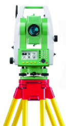
Máy toàn đạc
